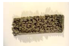
Oberfläche mit Dendriten
