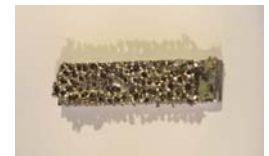
Oberfläche mit Wasserstoffblasen
